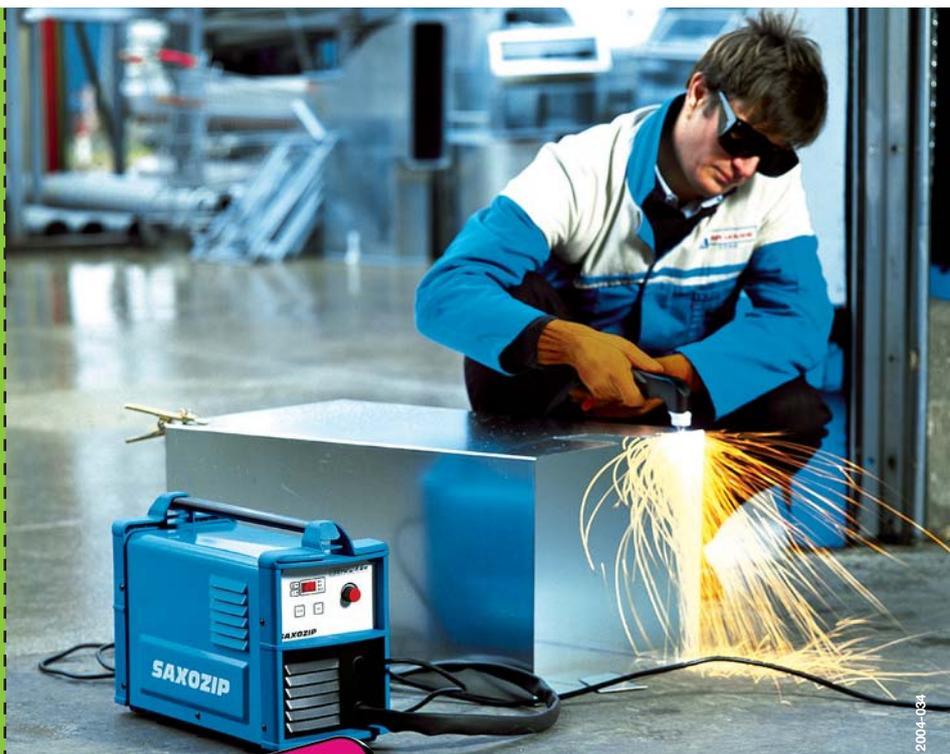
La soluzione portatile con compressore d'aria integrato per il taglio plasma manuale.
