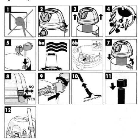
Dopo aver verificato lo scollegamento dalla rete (1), rimuovere il fermo a clip superiore (2) ed estrarre il corpo motore (3) dentro il quale sono posizionati gli accessori e le parti da montare (4). Estrarre tutto, montare le ruote (5), inserire il filtro in plastica per l'aspirazione di liquidi (6a). E'
