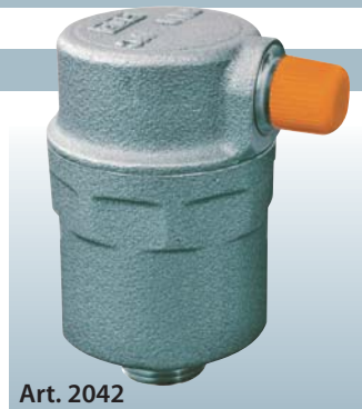
Fig.1 - In assenza di aria nel circuito, l'acqua all'interno della valvola di sfogo mantiene il galleggiante in posizione tale da chiudere l'otturatore.
