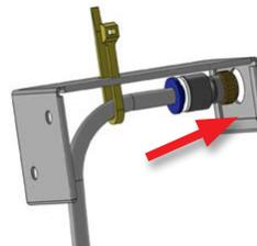
10. Fissare il tubo alla staffetta mediante la fascetta a corredo (da inserire nei fori predisposti);
