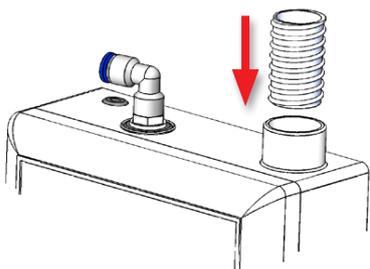
6. Inserire una estremità del tubo a corredo nel raccordo di **Neby** e verificare che il tubo sia bloccato sul raccordo;
