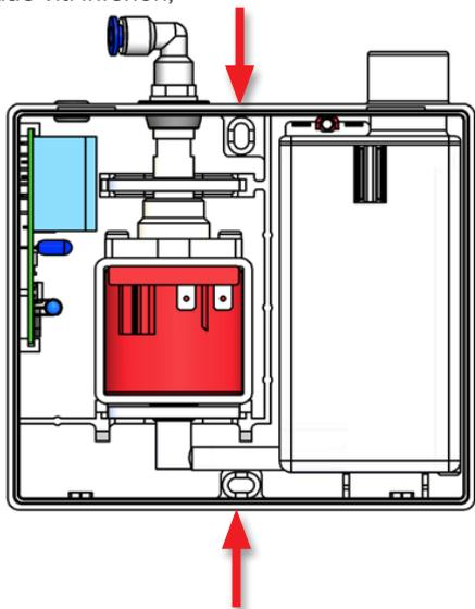
5. Inserire il tubo di scarico della condensa nel foro di ingresso (il foro è predisposto per corrugati da  $\varnothing 16$  a  $\varnothing 22$ mm);
