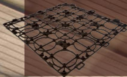
Listoplate è dotato di innovativi collegamenti che, oltre a facilitare l'installazione e la rimozione del deck, assorbono le dilatazioni termiche grazie ad uno speciale dispositivo elastico che garantisce uniformità di aggancio e disposizione.
