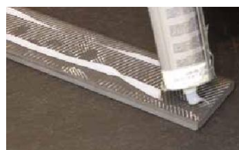
2. Incollare, con collante adeguato, la striscia di ceramica alla griglia di supporto.
