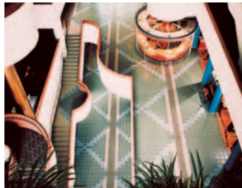
Grès porcellanato posato con Kerabond T + Isolastic - Civic Center - North York Ontario (Canada)
