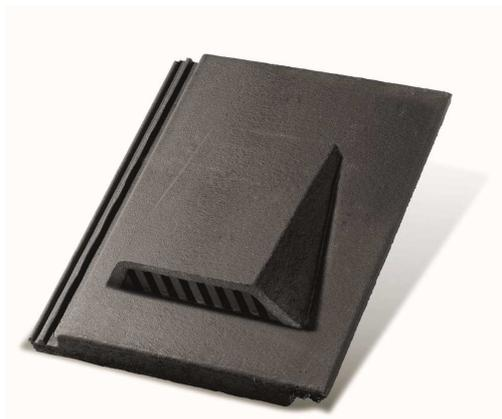
Si tratta di una speciale tegola provvista di foro e cappuccio che crea un passaggio di aria e permette la fuoriuscita dell'umidità ottimizzando il rendimento degli isolanti. Una griglia evita il passaggio di foglie ed uccelli. La posa viene eseguita come per una tegola convenzionale, ed è disponibile per tutti i profili e colori di tegole a listino.
