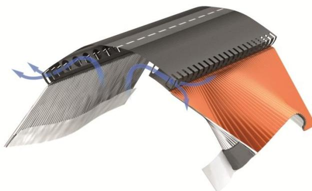
Sottocolmo impermeabile, con alette laterali in alluminio plissettato e colla butilica integrata resistenti ai raggi UV diretti. La sezione centrale è dotata di feltro in polipropilene resistente ai raggi UV indiretti con doppio canale di ventilazione (patentato) per garantire un'altissima aerazione.
