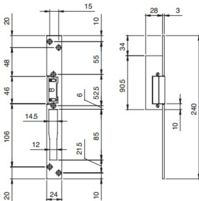
Incontro elettrico con frontale piatto acciaio INOX mm **240x24x3**, per serrature da infilare con SCROCCO e CATENACCIO basculante per serramenti in alluminio, utilizzabile: PER MONTANTE CON SERRATURA INTERNA DESTRA, PER FASCIA CON SERRATURA INTERNA SINISTRA, **APERTURA CON SGANCIAMENTO PERMANENTE DOPO L'IMPULSO ELETTRICO**, con leva fermo a giorno, perno di presenza scrocco. Voltaggio: **12Vac 15W.**
