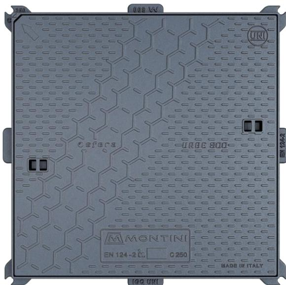
**DESCRIZIONE** Dispositivo di chiusura in ghisa sferoidale GJS 500-7 secondo la norma EN 1563, conforme alla norma EN 124-2:2015 in particolare conforme alla classe di portata C250, carico di rottura >250 kN ( $\geq t 25$ ), recante il marchio di certificazione di prodotto IGQ (Istituto Italiano di Garanzia della Qualità) ed il marchio di conformità UNI.
