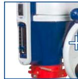
Dispositivo frontale d'arresto della profondità di foratura.
