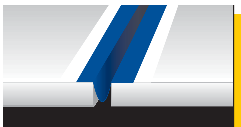
Posizionamento a omega di Mapeband all'interno del giunto di dilatazione
